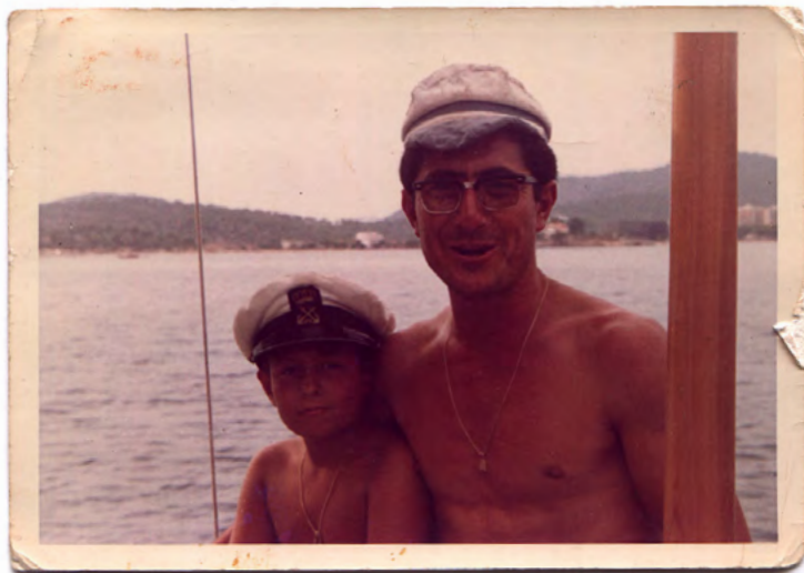
5.1.4.b "Copia en tintes de color cromógeno conservada en oscuridad, presenta pérdida de densidad y cambio de color por el desvanecimiento del tinte cian".
