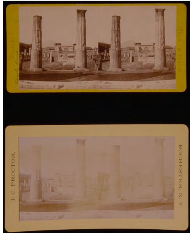
5.1.b "Dos pares estereoscópicos, el superior, a la albúmina presenta un leve deterioro por foto oxidación; el inferior al colodión de ennegrecimiento directo presenta una severa sulfuración por química residual debido a un procesado deficiente".
