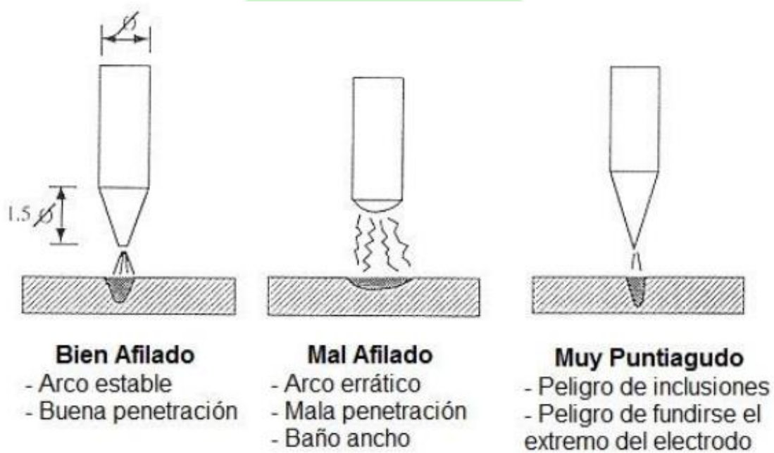
Figura 5. Influencia del afilado del electrodo en la calidad de la soldadura
