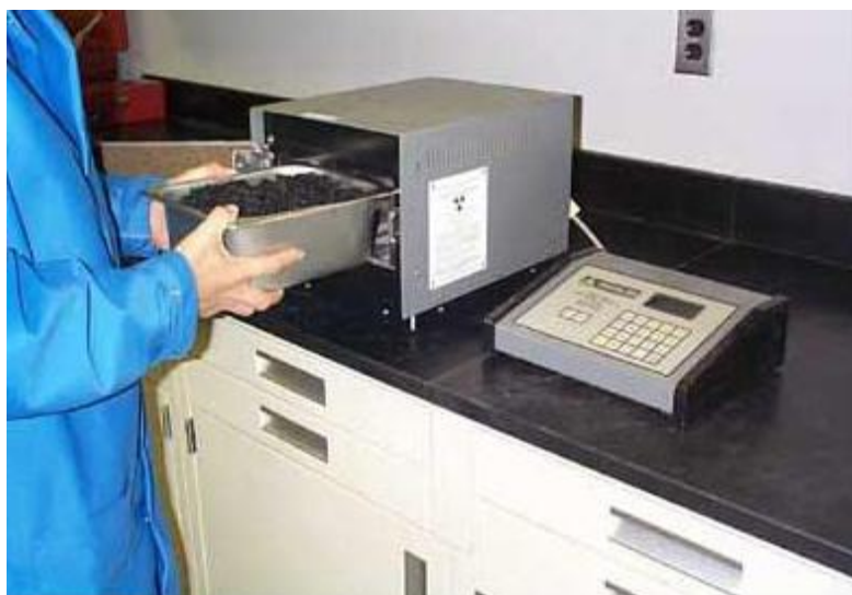
Ilustración 24 – Medidor Nuclear de contenido de asfalto
