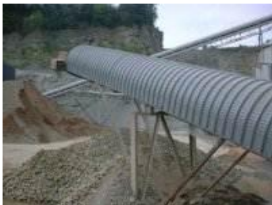
Ilustración 13 - Sistemas de mitigación de emisión de material particulado
