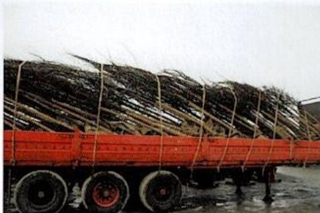
Figura 104. Modo de colocación del arbolado en camión.
