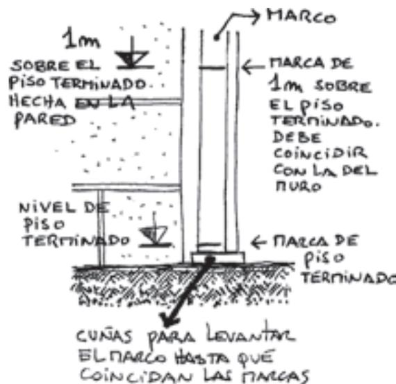
Nos queda nivelar el marco usando la plomada como indica el dibujo. En ambas direcciones, para asegurarnos que quede bien aplomado.
