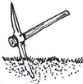
Si para excavar hay que perforar a pico con un gran esfuerzo, diremos que el suelo es duro. Su resistencia es muy buena.
