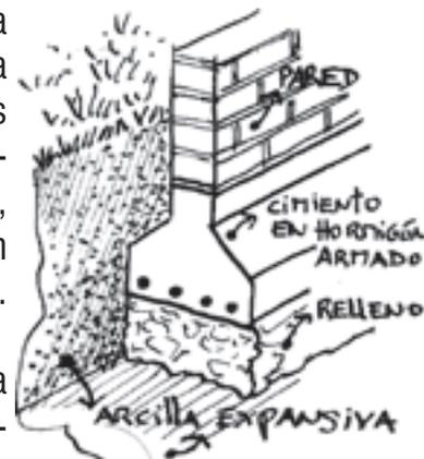
Un sistema que ha mostrado dar resultado cuando se usa en estos terrenos, una cimentación corrida de hormigón ciclópeo, es el colocar una capa de hormigón armado por debajo y por encima de la misma.
