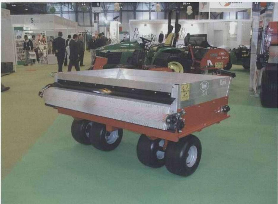
Foto 2.32.—Remolque repartidor de arena o mantillo.
