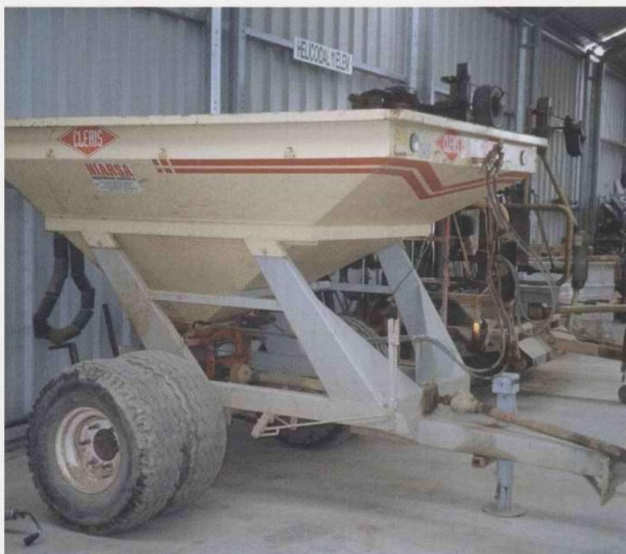
**Foto 2.30.**—Remolque arrastrado por tractor, para reparto de enmiendas o abonos de todo tipo.
