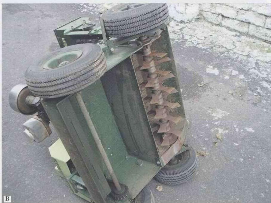
Foto 2.26.—Equipo "verticut" autopropulsado para pequeñas superficies: A. Vista frontal del equipo. B. Detalle de las cuchillas "verticut". (Fotos cortesía de D. Jose Antonio Lara Lara).
