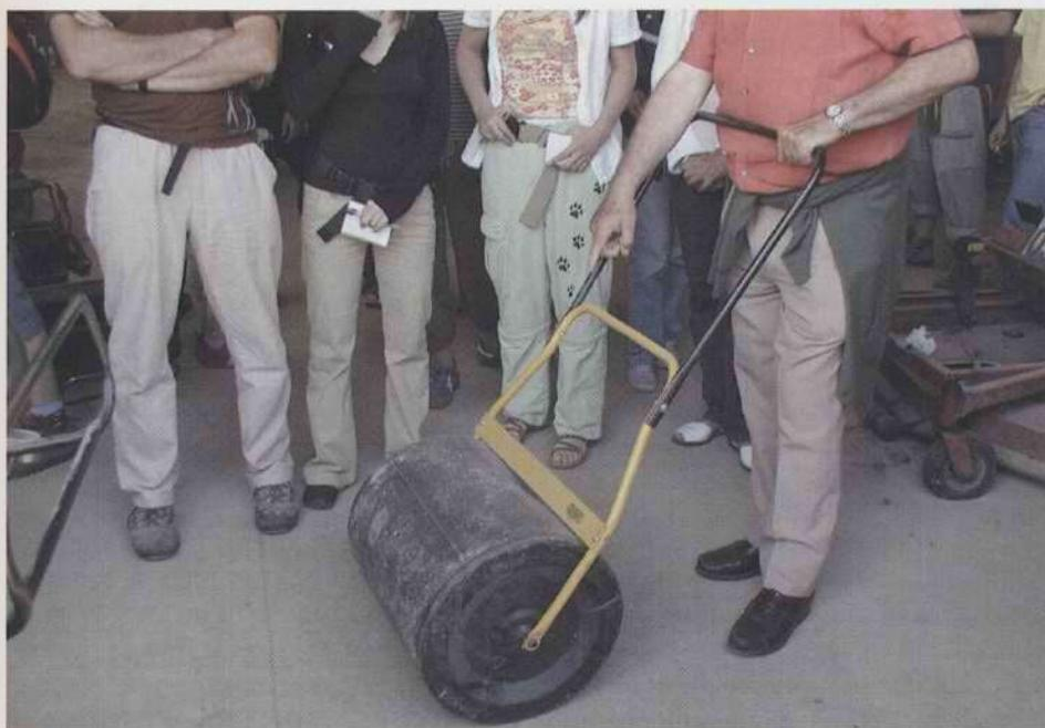
**Foto 2.15.**—Rulo manual ligero de plástico semirrígido, rellenable con agua para darle peso, utilizable en trabajos de mantenimiento de jardinería en pequeñas superficies.
