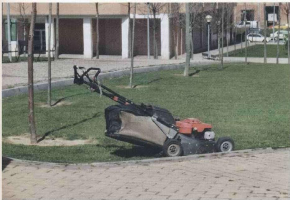
**Foto 2.3.**—Segadora manual rotativa auto-propulsada, equipada con bolsa de recogida de residuos de siega.
