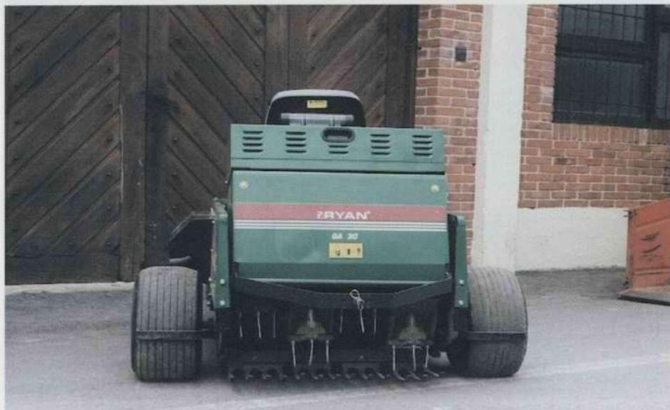
Foto 2.20.—Equipo mecánico auto-propulsado, de gran rendimiento para aireado del césped.
