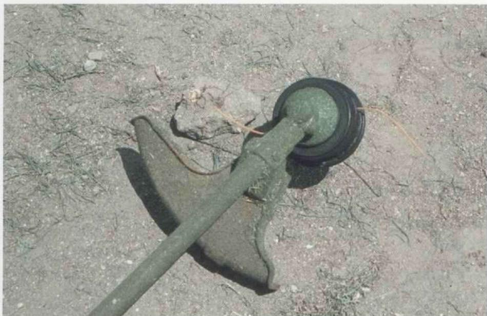
Foto 2.13.—Detalle del cabezal de trabajo, equipado con hilo de siega.
