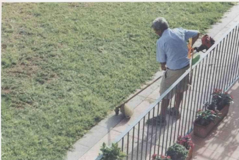
Foto 2.17.—Trabajo manual de perfilado del césped, con desbrozadora de hilo.
