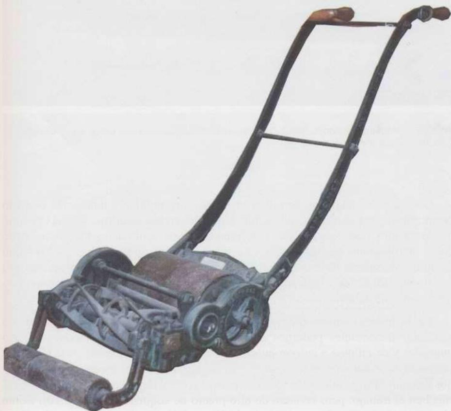
**Foto 2.6.**—Segadora manual helicoidal. Obsérvese el rulo afirmador posterior al cuerpo de cuchillas.
