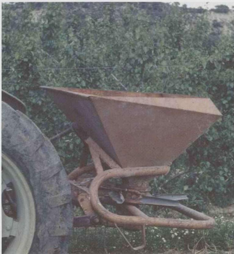
**Foto 2.29.**—Abonadora centrífuga montada sobre tractor, para reparto mecánico de abonos granulados o cualquier enmienda cálcica.
