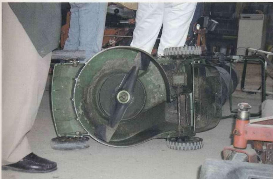
**Foto 2.4.**—Detalle de la cuchilla y de la carcasa, vistas por debajo, en una segadora manual rotativa auto-propulsada.
