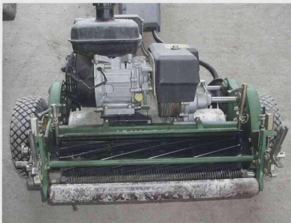
**Foto 2.7.**—Máquina segadora helicoidal autopropulsada, equipada con peine acondicionador delantero y rulo afirmador posterior.
