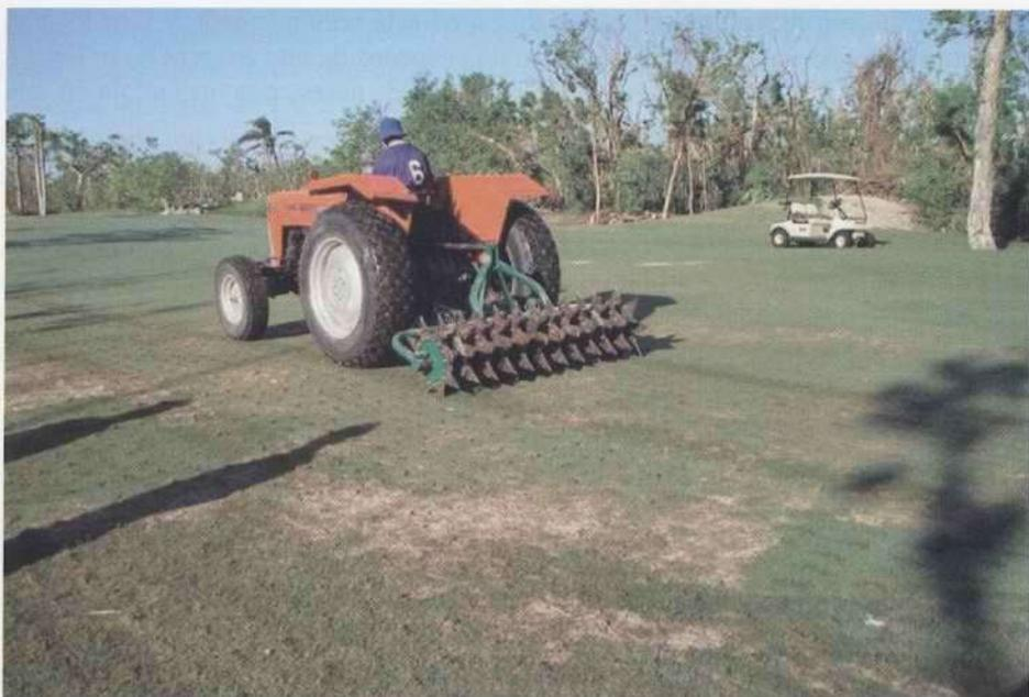
**Foto 2.21.**— Trabajo de aireado previo a aportaciones de arena o resiembras de céspedes en mal estado.
