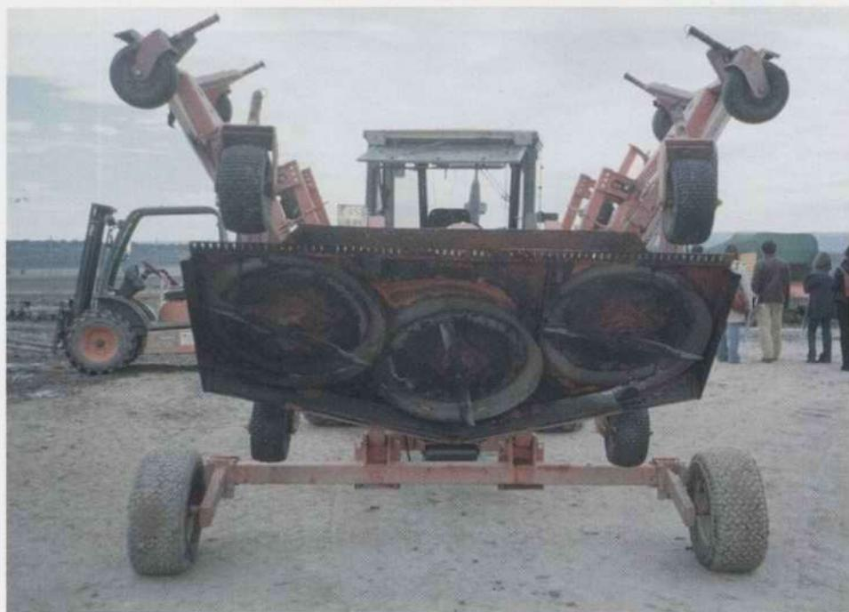
**Foto 2.5.**—Segadora rotativa múltiple (3 cuerpos y 9 cuchillas) de gran rendimiento, arrastrada por tractor.
