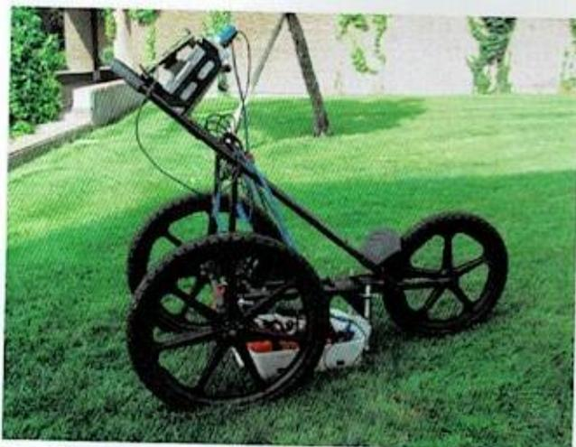
Figura 67. Sistemas como Tree-Radar muestran el desarrollo y la profundidad de las raíces.
